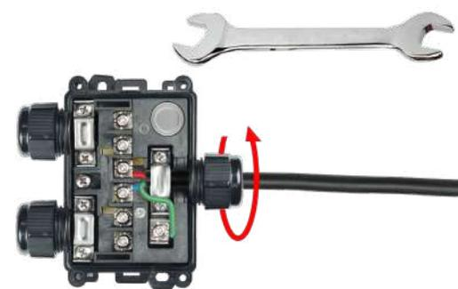
4: 将圆形的电缆密封件滑入电缆接头并拧紧螺母。最大扭矩为 3N.m。
