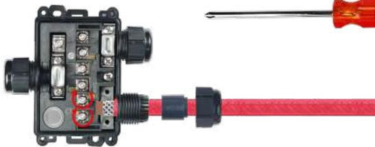
9: 将总线导线和编织层放在其将要拧紧的位置。拧紧总线上的接线端子螺丝。建议的力度为 1.2 Nm。
