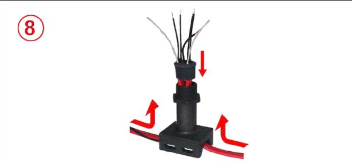
8: 将支脚放置在发热电缆和温度传感器电缆上，从上方将其取出，然后将垫圈滑到电缆上。外部绝缘护套必须从垫圈中伸出。
