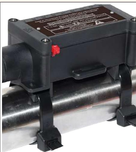
2: 两个可拆卸的 PA66 塑料调节片，用于固定在管道，距离管道之间提供了一个 10mm 的扩展安装位置。对于绝缘层厚度低且管道温度低于 100°C 的应用而言，这是理想的并且经济的。可以使用尼龙扎带或金属夹子将金属或 PVC 管道夹紧 (这些调节片是标配的)。
