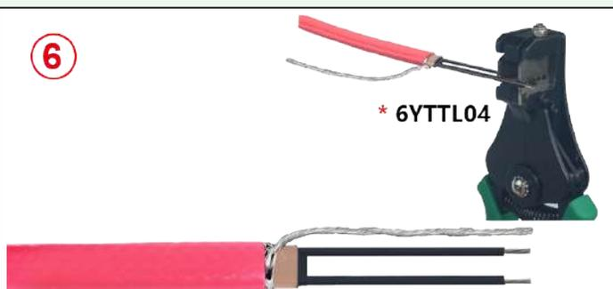
6: 剥去留在总线末端的半导体塑料层至要求的长度。
