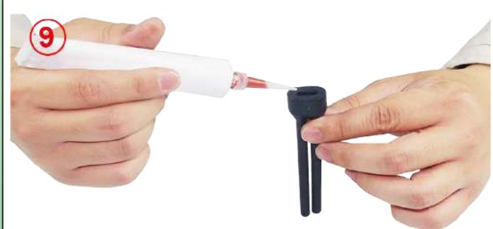
9: 将硅树脂 (室温硫化) 注入硅胶套的电线输入孔里。
