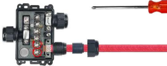
9: 将总线和编织层放在其将要拧紧的位置。拧紧总线上的接线端子螺丝。建议的扭矩为 1.2Nm。
