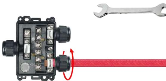
11: 将平的电缆垫圈滑入电缆接头并拧紧螺母。最大的扭矩为 3Nm。连接其他的电缆并合上盖子。
