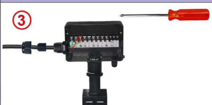
3: 将地线滑入地线端子并拧紧螺丝。建议的力度为 1.6Nm。
