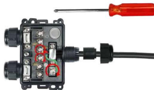
2: 将零线、火线和地线放入螺丝端子内，并拧紧。建议的扭矩为 1.2Nm。
