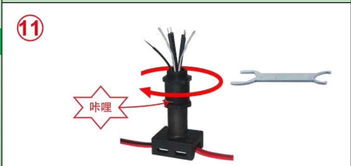
11: 通过拧紧支脚的上部配件进行压缩密封件。拧紧后，一个小卡簧会挡住该组件 (拆卸时，有必要卸下该小的半圆形的卡簧)。然后，也可以通过一个 32.5mm 的孔将此支脚安装在选定的外壳。
