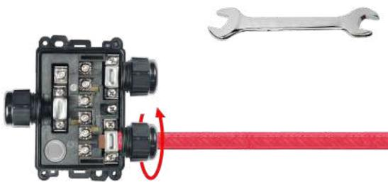
11: 将平的电缆垫圈滑入电缆接头并拧紧螺母。最大的力度为 3Nm。连接其他的电缆并合上盖子。
