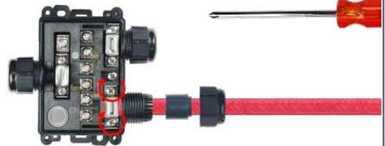
10: 装回鞍座并将其拧紧在金属编织层上。建议的力度为 1.2Nm。
