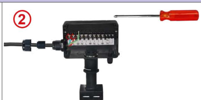
2: 将零线和火线放入螺丝端子内，并拧紧。建议的力度为 1.6Nm。
