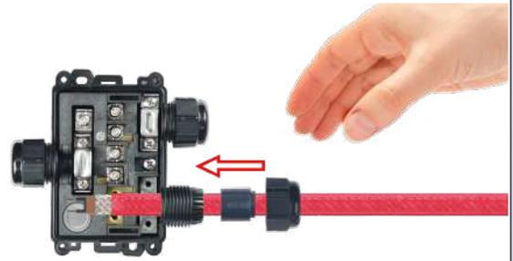
8: 松开并卸下鞍座，必要时松开并卸下端子螺丝，然后将电缆穿过电缆接头。
