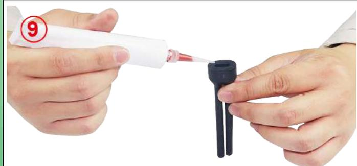
9: 将硅树脂(室温硫化)注入护套电线的输入孔里。
