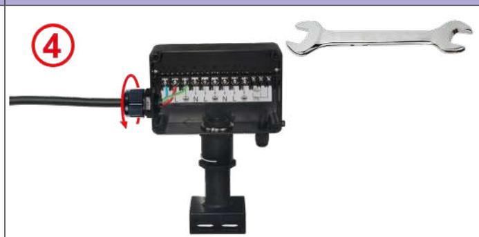
4: 将圆形电缆的垫圈滑入电缆接头并拧紧螺母。最大力度为 6N.m。
