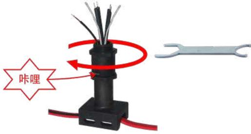
11: 通过拧紧脚部的上方进行压缩密封。拧完后，一个小卡簧会挡住组件（拆卸时，有必要卸下这个小的半圆形的卡簧）。
