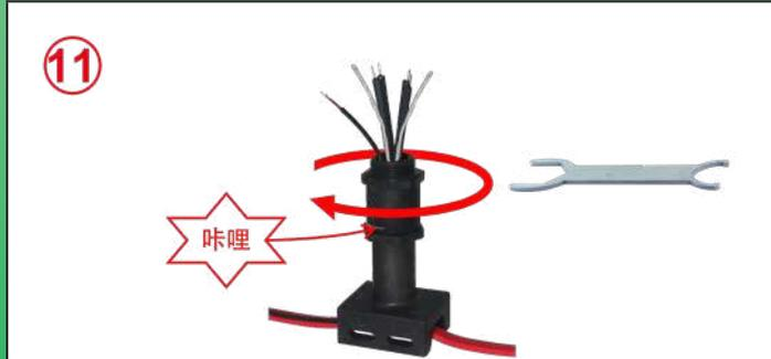
11: 通过拧紧支脚的上部配件进行压缩密封件。拧紧后，一个小卡簧会挡住该组件(拆卸时，有必要卸下该小的半圆形的卡簧)。
